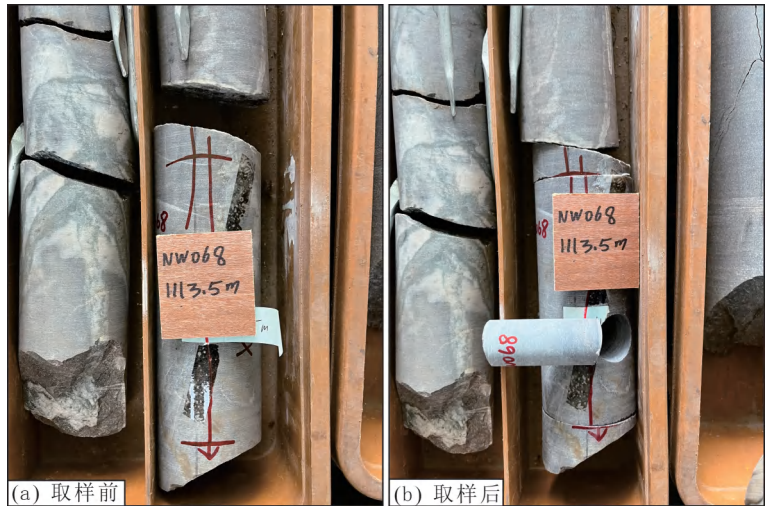
图4 南岭科钻 SP-NLSD-2岩芯取样后样品归位对照图
