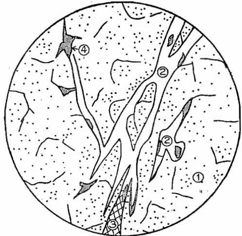
图7 图示方解石石英和輝鉬矿的生成晚于矽嘎岩
