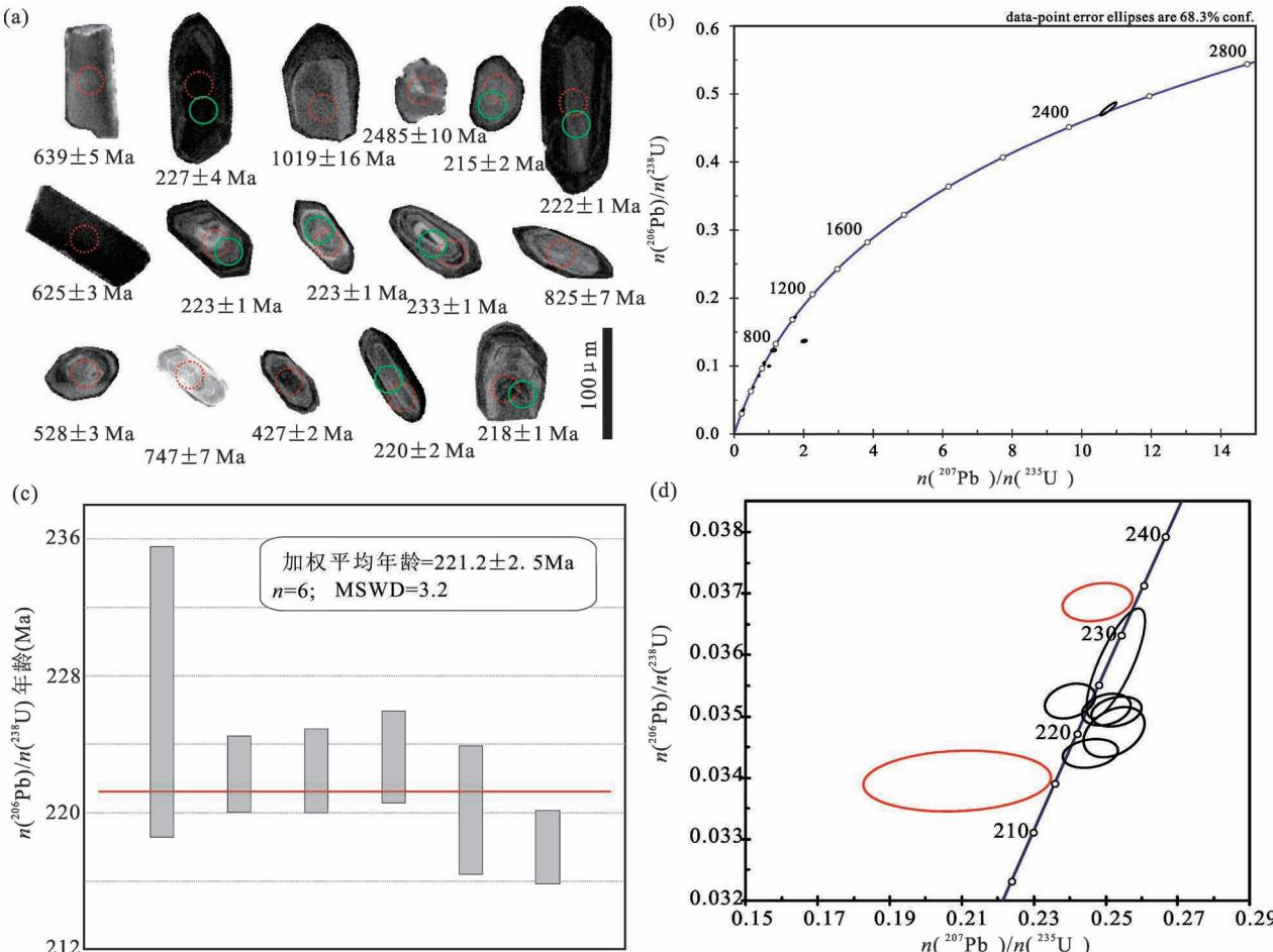
图4 十堰黄龙一方滩地区辉长岩锆石 U-Pb 年龄及 CL 图像(红色圆圈为锆石测年点, 绿色圆圈为 Hf 同位素测试点)
