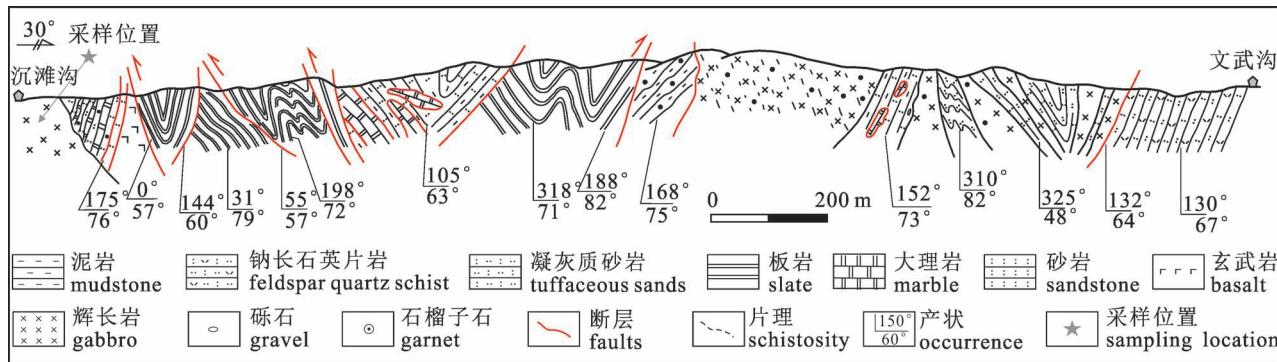
图2 湖北十堰黄龙沉滩沟-文武沟信手剖面图(据王刚等,2018)
