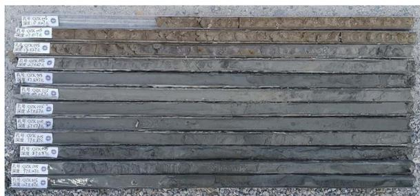
图10 Φ50mm 双管冲击钻具取得砂泥质样品
