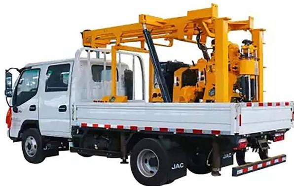
图 3 XYC-200 车载钻机
