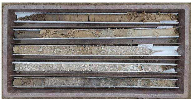
图8 Φ60mm 半合管钻具取得的砾质样品
