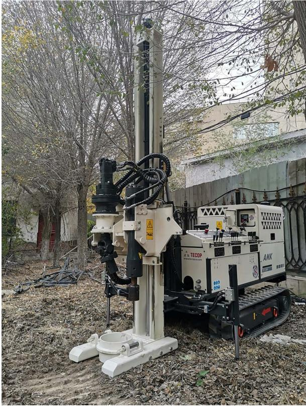
图4 TEC-12DP 液压直推取土钻机
