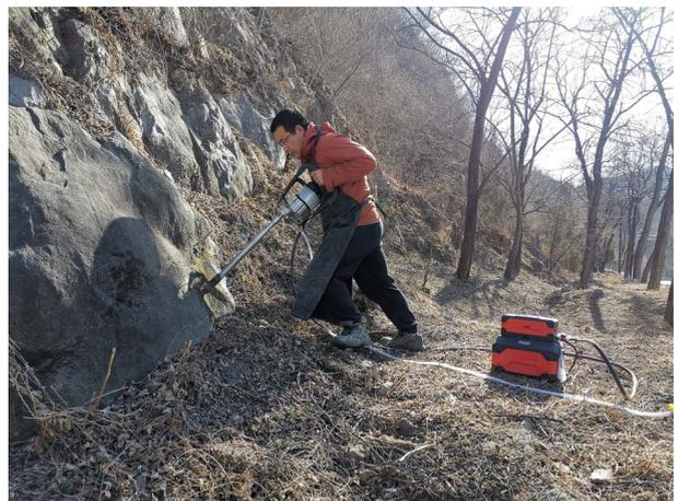
图6 TGQ-10DC 电动钻机岩石取样试验现场
