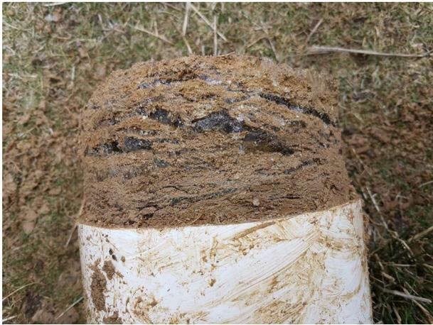
图11 中空螺旋钻具钻取的含冰冻土
