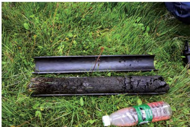
图5 单管钻具取得泥炭样品
