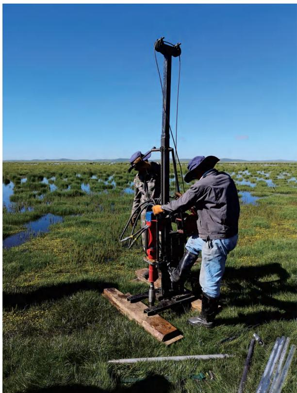
图6 双管取样试验现场
