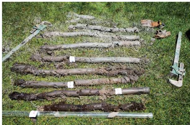
图7 双管钻具取得泥炭样品
