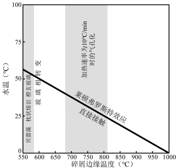
图 5 直接的岩浆—水接触和有稳定蒸汽膜的形成时水和碎屑边缘的温度条件(莱顿弗罗斯特效应;修改自 Dhir & Puhorit, 1978)
