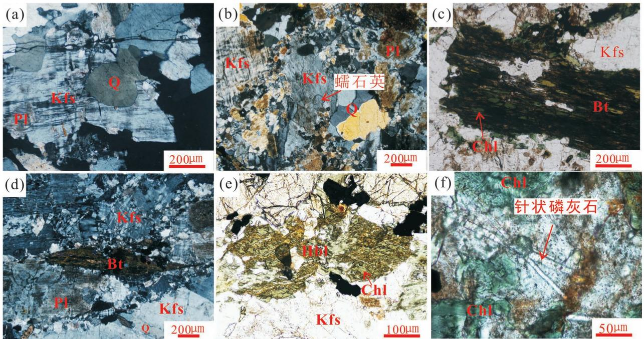
图2 龙首山茱岭正长岩岩相学显微照片:(a)呈圆形具有波状消光的石英;(b)在钾长石中包裹着一颗蠕石英;(c)黑云母沿解理缝有铁质矿物析出并有绿泥石化作用;(d)受应力作用发生变形的云母,发生绿泥石化蚀变,解理缝有铁质矿物析出;(e)被交代和发生绿泥石化的角闪石;(f)针状磷灰石
