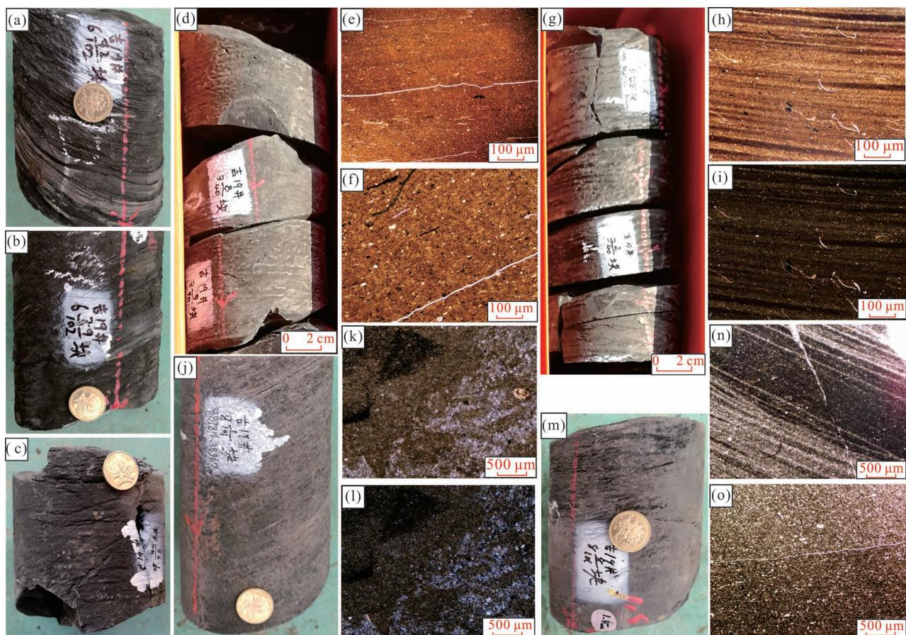
图 2 苏北盆地古近系阜宁组二段不同岩性岩芯及镜下薄片特征
