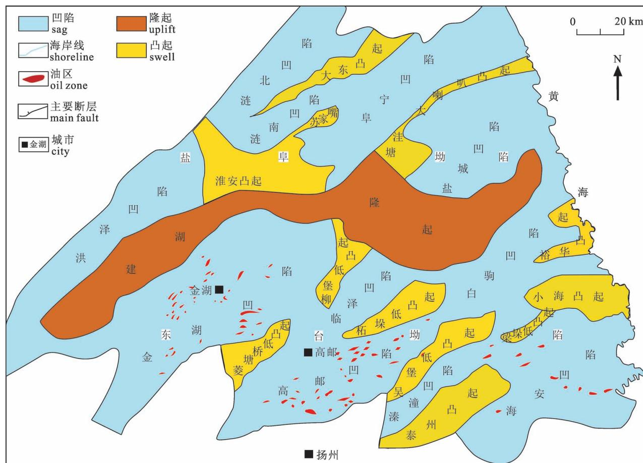
图1 苏北盆地构造带划分图(据 Zhang et al. , 2014; Liu Jingshou et al. , 2018; 王旭影和姜在兴,2021 修改)
