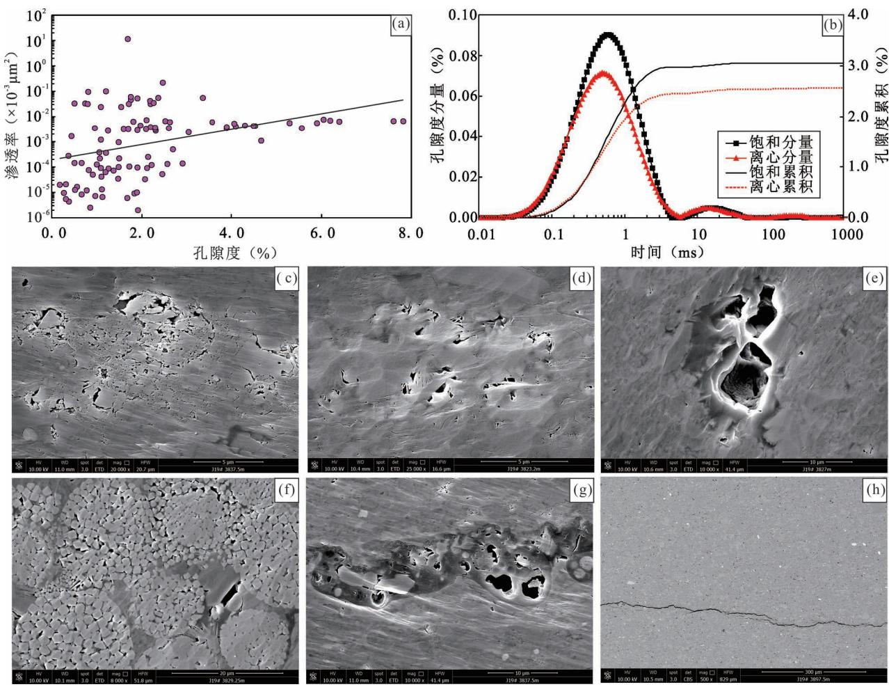
图3 苏北盆地古近系阜宁组二段孔渗关系、核磁共振 $T_2$ 谱以及不同储集空间扫描电镜照片
