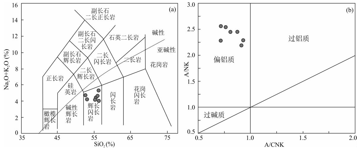
图 4 哮嘛山辉长闪长岩 TAS 图解(a)(据 Le Maitre R W, 1989)
