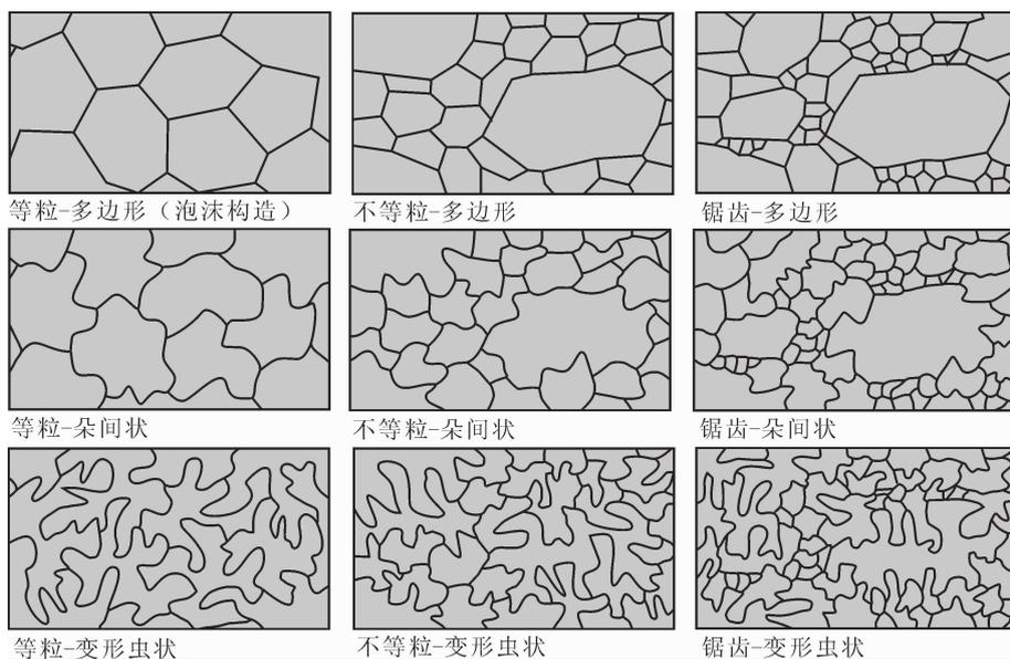
图6 朵间状等颗粒边界示意图 (Passchier et al., 2005)
