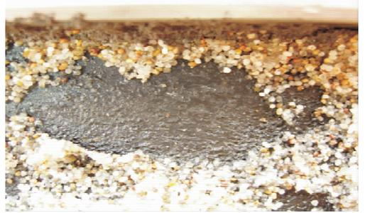
图 9 实验结束后 3 h 支撑剂压入的实验结果
