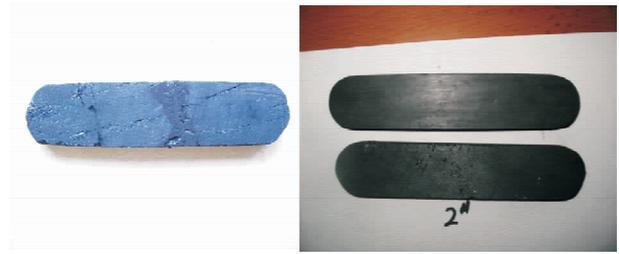
图 1 煤岩裂缝导流实验的岩样照片
