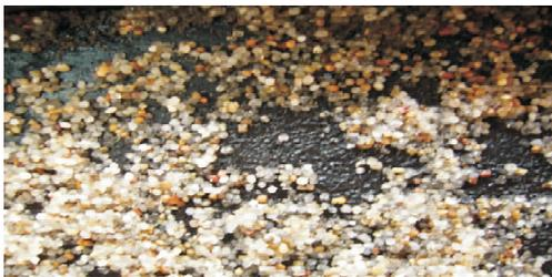
8 实验结束后 30 min 支撑剂压入的实验结果
